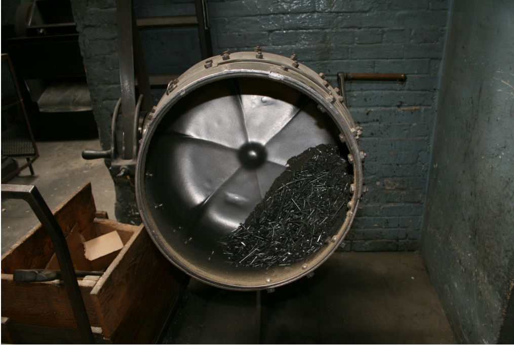
Maschinenpark der Schweizerischen Nagelfabrik, Putztrommel, 25.08.2016 (Bild Nr. D101112_18).
