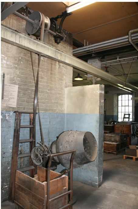
Maschinenpark der Schweizerischen Nagelfabrik, Putztrommel mit Transmissionssystem, 25.08.2016 (Bild Nr. D101112_19).
