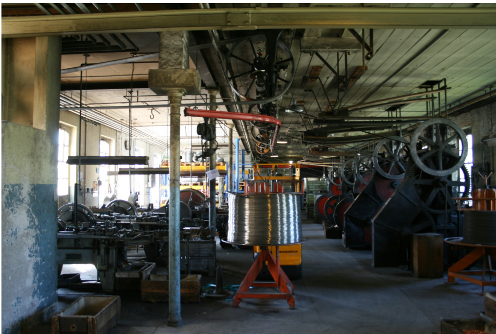
Maschinenpark der Schweizerischen Nagelfabrik, Maschinenpark mit horizontalen und vertikalen Schlagmaschinen, 25.08.2016 (Bild Nr. D101112_04).
