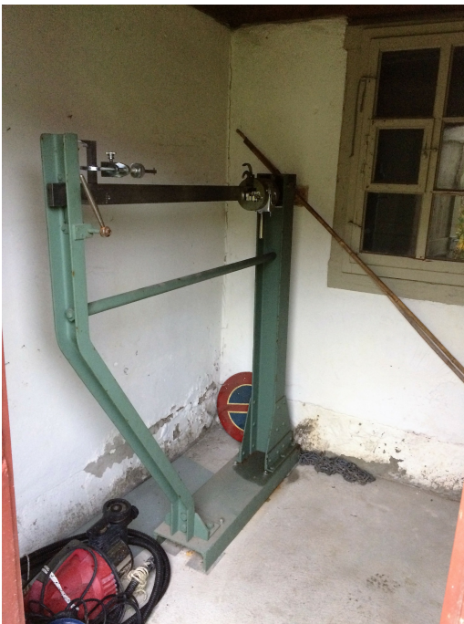
Brückenwaage, Innenaufnahme Laufgewichtsbalken, 15.11.2016 (Bild Nr. D101076_56).
